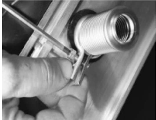
Fig. 31 Serrer le collier sur le flexible et sur la sortie capteur à l'aide d'une clef allen.
