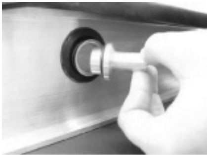
Fig. 32 Pour les connections aux canalisations il existe des raccords lisse en diamètre 12, 15, 18, 22 mm. ces raccords se montent sur les capteurs de la même manière que les raccords intercapteurs.
